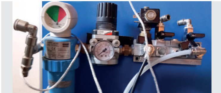
Imagen D. 13. 4. Manifold de electroválvulas con electroválvulas
